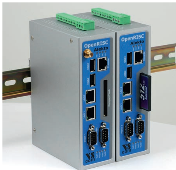
► OpenRISC Alekto – промышленный встраиваемый компьютер на RISC-процессоре, плод усилий в том числе и команды OpenCores.
