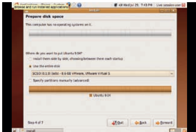
Установка Ubuntu или другого дистрибутива на внешний диск в основном зависит от выбора правильного устройства.
