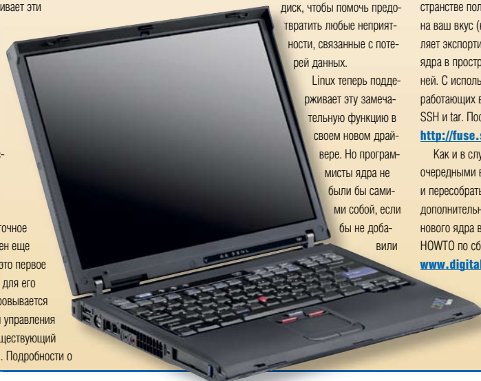
Ноутбук IBM ThinkPad, определяя состояние падения, фиксирует головки жесткого диска всего за 500 миллисекунд.
